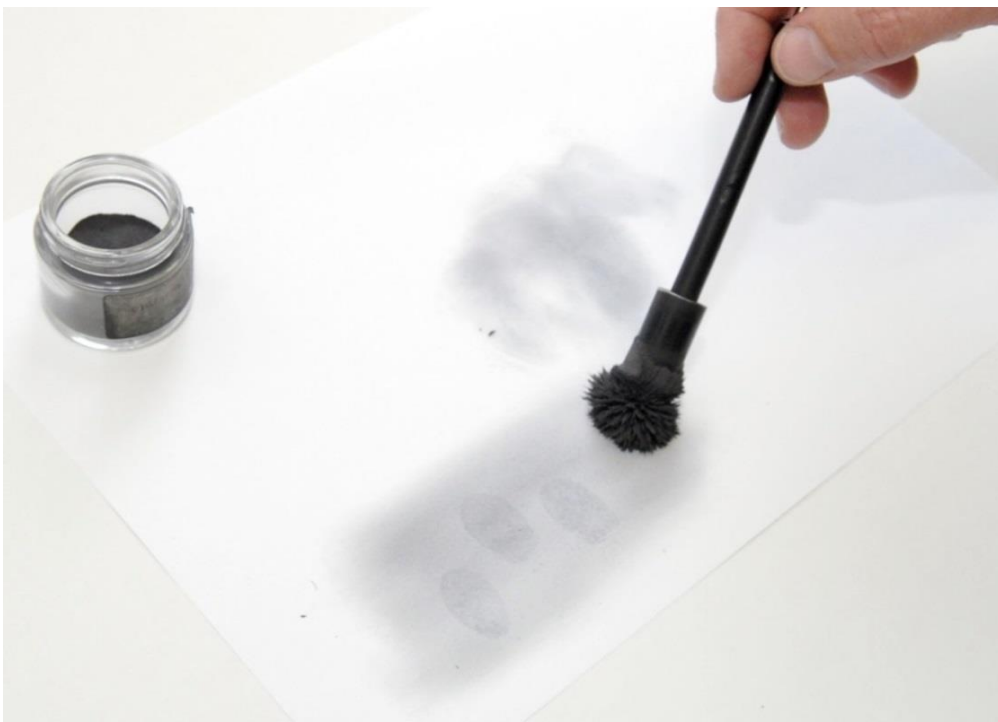
Abb. 33. Magna Brush-Pinsel. Die Metallspäne halten sich an dem magnetisierten Stab fest. Indem sich das breitere Bauteil des Pinsels nach unten schieben lässt, lassen sich nach dem Abpinseln des Spurenträgers – im vorliegenden Fall ein Blatt Papier - die überzähligen Späne wieder abstreifen (Quelle: PP Essen)
