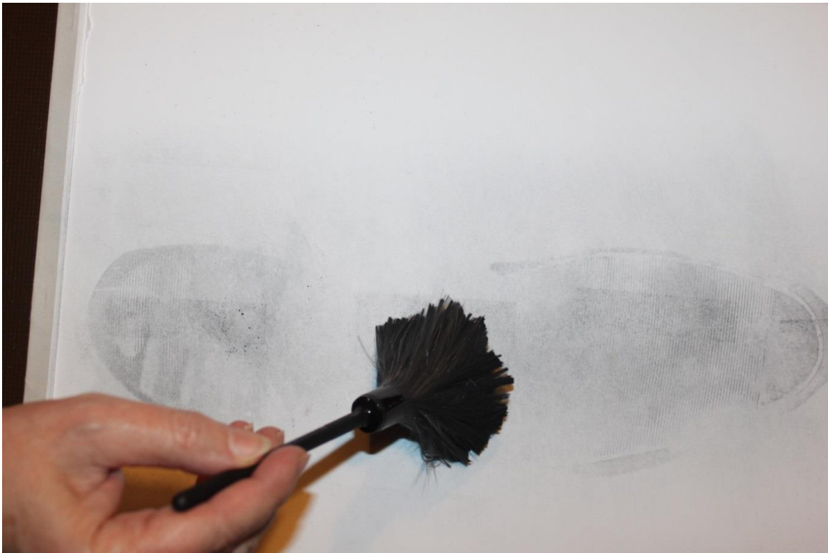
Abb. 81. Sichtbarmachen einer Schuhspur auf Papier mit Zephirpinsel und Rußpulver (Quelle: Kawelovski)
