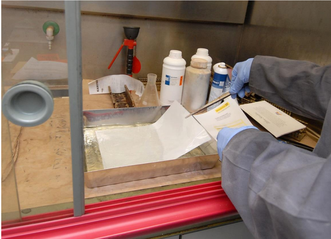
Abb. 37. Ein Spureträger – hier ein Blatt Papier – wird durch das Ninhydrinbad gezogen (Quelle: PP Essen)
