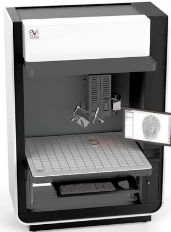
Abb. 26. EVISCAN-Gerät. Auf dem Bild ist als Spureträger ein Smartphone, auf dem ein Fingerabdruck detektiert werden konnte, auf der Scanfläche abgelegt. Darüber befindet sich die Scankamera. Die erkannte Spur ist auf dem Monitor an der Front des Gerätes (rechts) abgebildet (Quelle: Fa. German eForensics).
