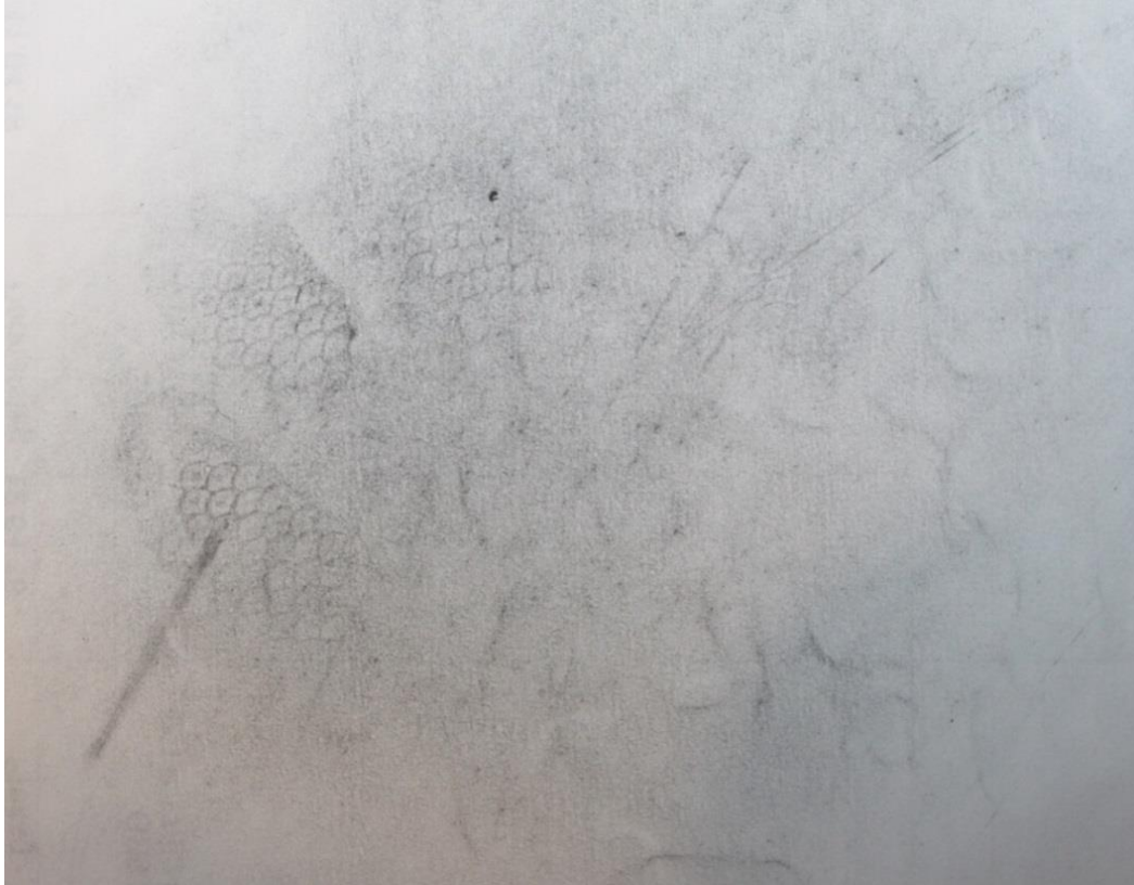
Abb. 29. Mit Rußpulver sichtbar gemachte Handschuhspuren (Quelle: Kawelovski)
