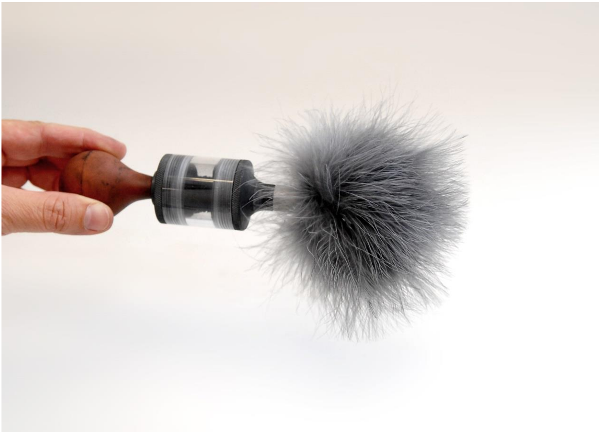
Abb. 15. Containerpinsel zum Sichtbarmachen latenter Spuren. Der Kunststoffcontainer in der Mitte ist mit Rußpulver befüllt. Durch Druck auf den Gummibalg an der linken Seite wird Rußpulver durch eine Düse in die Pinselhaare gedrückt (Quelle: Kawelovski)
