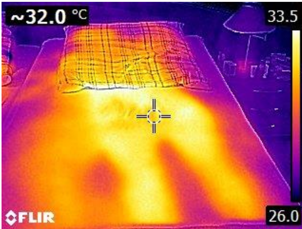
Abb. 118. Liegespuren auf einer Kaltschaummatratze nach 9 Stunden Liegezeit. Man kann erkennen, dass eine Person zuletzt in Rückenlage gelegen hatte (intensivere Wärmeabstrahlung) und davor in Seitenlage gelegen haben muss (schwächere Wärmeabstrahlung)
