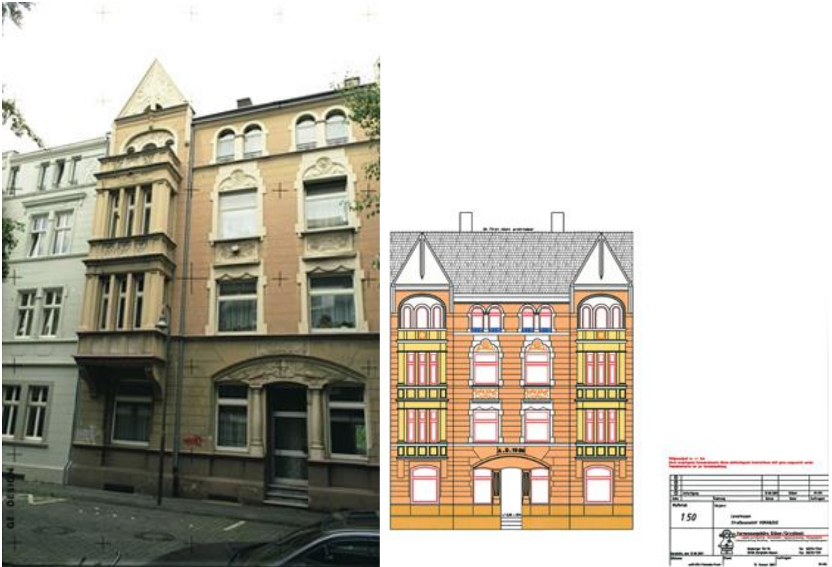
Abb. 19. Photogrammetrie. Links ein Gebäude perspektivisch verzerrt. Rechts das photogrammetrisch erzeugte Frontalbild (Quelle: PP Essen)
