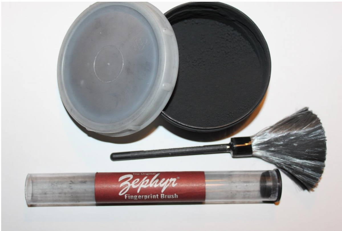
Abb. 14. Zephyrpinsel und Rußpulverdose zum Sichtbarmachen latenter Finger-, Handflächen-, Fuß- und Schuhspuren (Quelle: Kawelovski)
