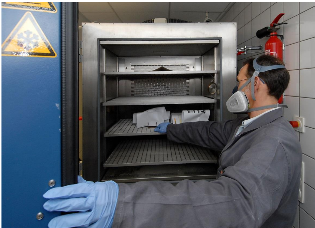
Abb. 38. Die mit Ninhydrin behandelten Spureträger werden für einige Tage in eine Klimakammer gelegt, damit sich die Spuren entwickeln (sichtbar werden) können (Quelle: PP Essen)
