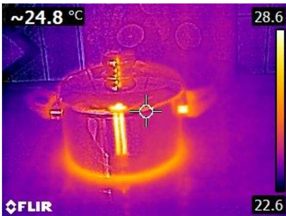
Abb. 119. Topf, in dem 2 Liter Wasser erhitzt wurden. Auch nach 12,5 Stunden ist die Erwärmung der Herdplatte immer noch deutlich erkennbar
