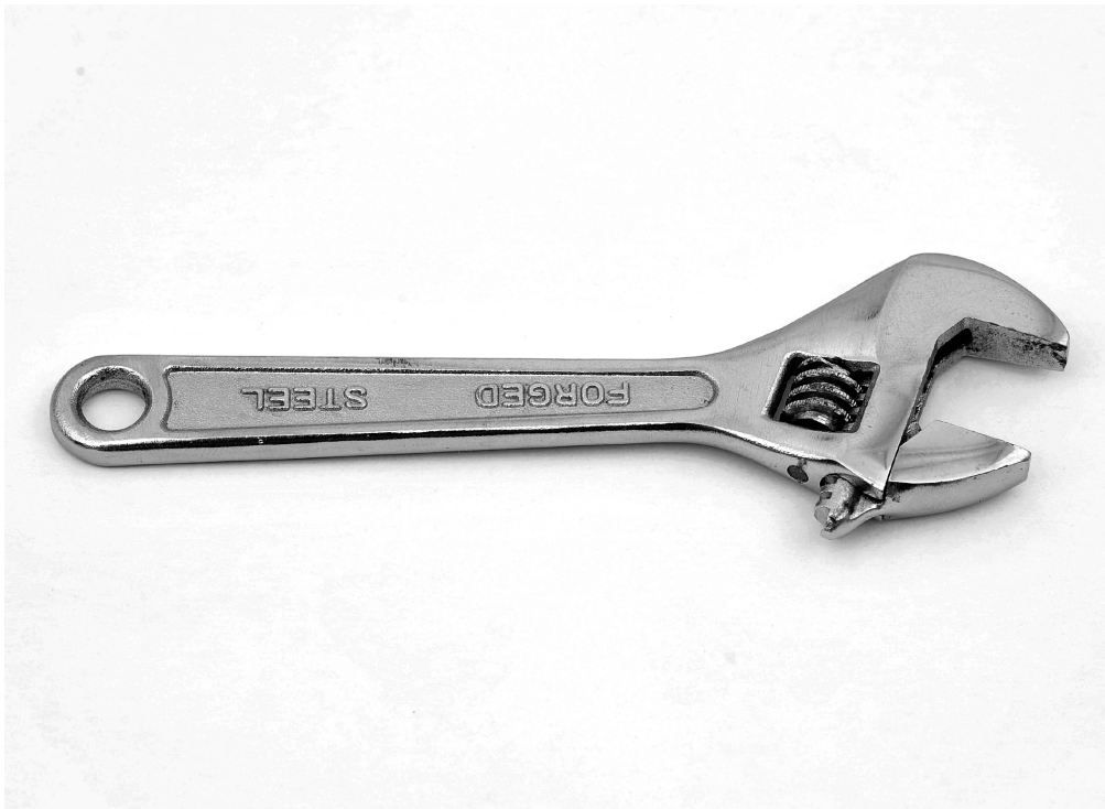
Abb. 27 (Quelle: Archiv Kawelovski) Rollgabelschlüssel, auch „Engländer“ genannt. Der Schlüssel wird an überstehenden Schließzylindern angesetzt und deren eingeklemmte Hälfte abgebrochen
