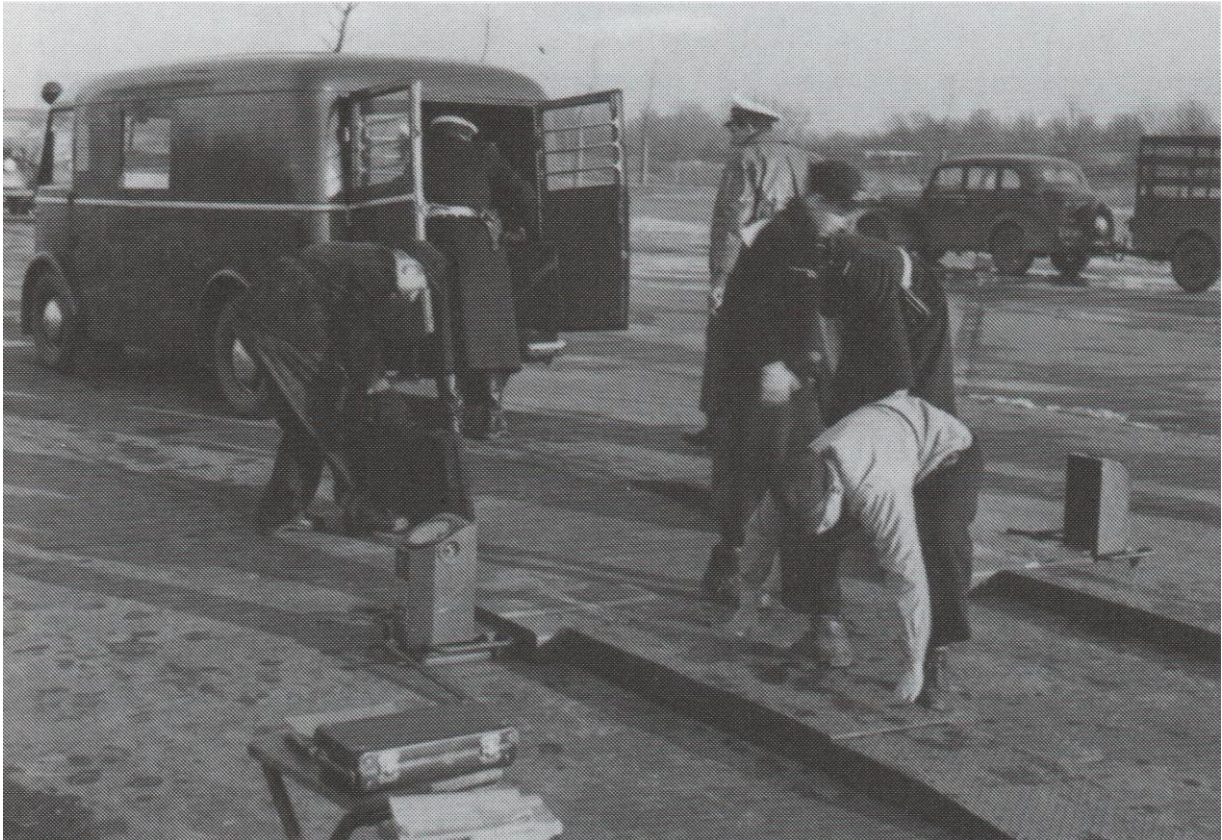
Abb. 5. Technische Prüfgruppe im Einsatz mit Radlastmesser und Geräuschprüfgerät (Quelle: Dieter Hochmanski)
